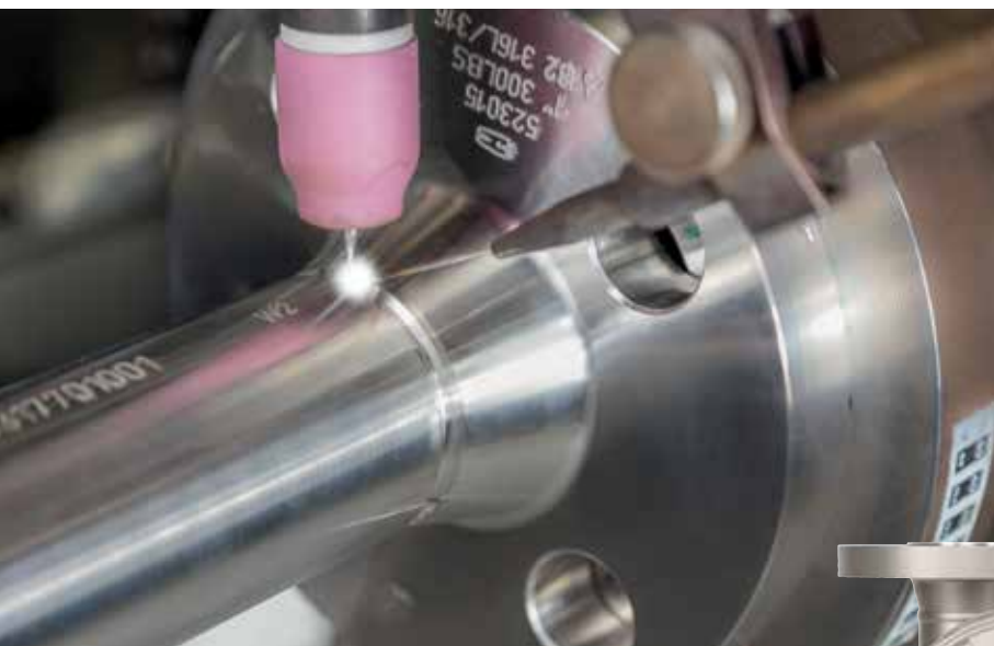
Processus de soudage automatique sur les débitmètres MT3809 VA à bride
