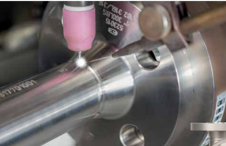
Orbinalschweißprozess am MT3809 Schwebekörperdurchflussmesser
